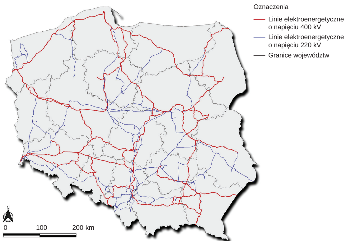
Ryc. 2. Przebieg sieci przesyłowej 400 kV i 220 kV.
